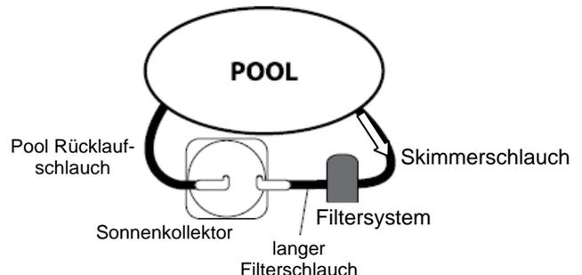
Positionieren Sie den Sonnenkollektor an einem sonnigen Platz, halten Sie jedoch einen ausreichenden Mindestabstand zum Pool ein. **Hinweis:** Schlauchverbindungen können bereits vorinstalliert sein.
