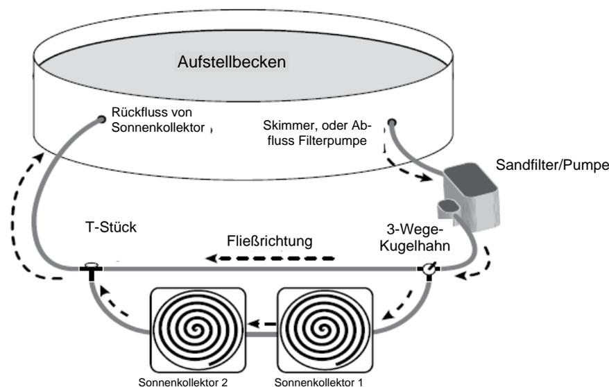
Das Wasser fließt durch die Filteranlage zum Sonnenkollektor und dann wieder zurück zum Pool.
